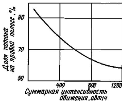
Рис. 9.18. Распределение интенсивности движения по полосам автомобильных магистралей
