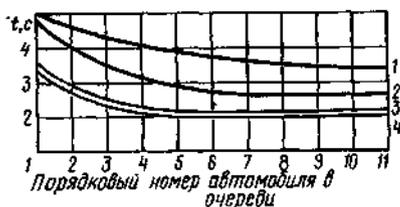
Рис. 3.6. Интервалы разъезда автомобилей из очереди у стоп-линии:
